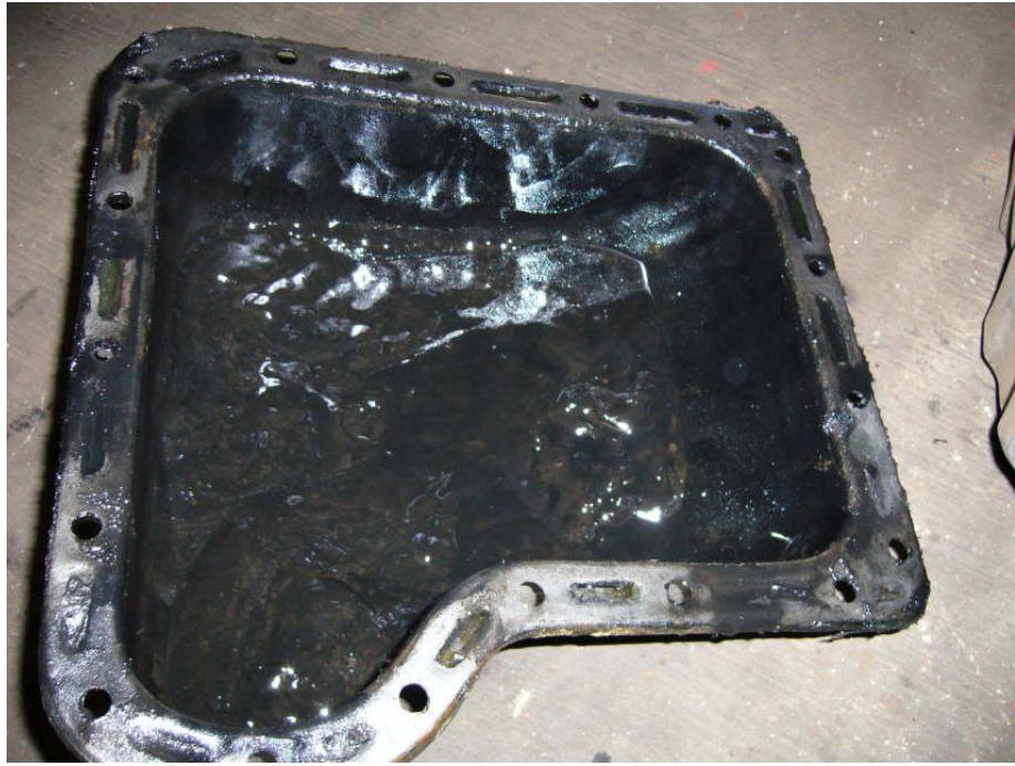
Wer jetzt denkt, dass sei eine Katastrophe, der liegt falsch. Ältere Motoren haben keinen richtigen Ölfilter. Es ist Absicht, dass der Dreck aus dem Motor sich nach und nach in der Ölwanne absetzt. Eigentlich sollte diese auch von Zeit zu Zeit gereinigt werden, aber welcher Landwirt hat schon die Zeit dazu...
